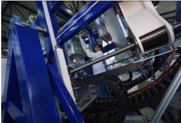
Spaltimprägnieranlage im IKV-Technikum für Faserververstärkte Kunststoffe (Foto: IKV/Winandy)
