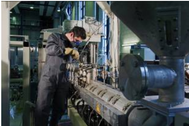
Regelung der Schmelzeentgasung im Extrusionstechnikum des IKV (Foto: IKV/Winandy)
